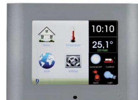
*Gestion de l'installation, thermostat incorporé, récepteur de télécommande IR, gestion températures, lumières, volets, son, énergie, touche eco*
